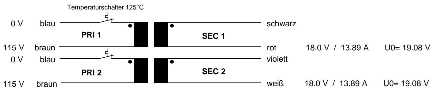
Verschaltungsmöglichkeiten: Parallelschaltung **115V** = blau mit blau und braun mit braun verbinden
