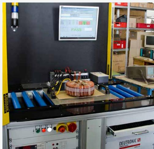
Testsystem für Transformatoren
