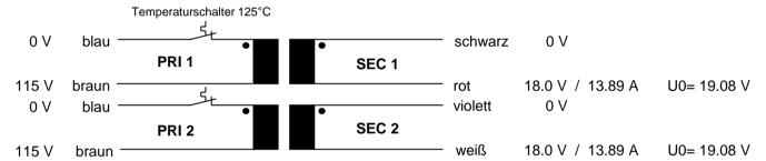
Verschaltungsmöglichkeiten: Parallelschaltung 115V = blau mit blau und braun mit braun verbinden
