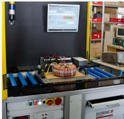
Testsystem für Transformatoren
