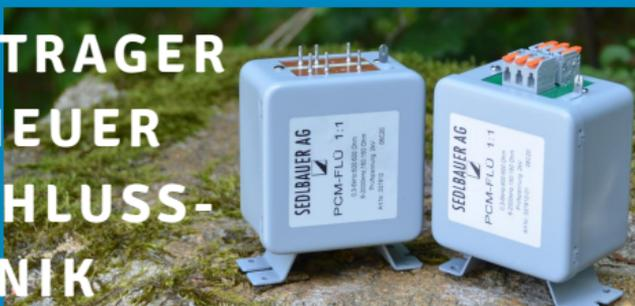
Die bewährten SEDLBAUER-Übertrager wurden einem Facelift unterzogen: Anstelle von Lötanschlüssen werden nun **Klemmen mit Push-in CAGE CLAMP®-Anschluss und Hebeln** verwendet. Damit ist ein direktes Stecken von eindrätigen Leitern und feindrätigen Leitern mit Aderendhülsen möglich. Die Bedienung ist intuitiv und kann ohne Werkzeuge vorgenommen werden.
