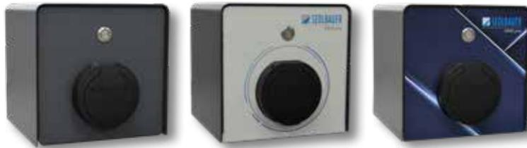
Die SlimBox zählt zu den kleinsten 22 kW-Ladeboxen der Welt. Sie eignet sich ideal für eine Wandmontage in der Garage oder am (Solar)-Carport. Die Sperrung erfolgt mittels abziehbarem Schlüsselschalter an der Unterseite der Box oder mittels potentialfreiem Kontakt (230AC, 100 mA). Die Wandhalterung ist im Lieferumfang enthalten. Optional ist eine Standsäule erhältlich.
